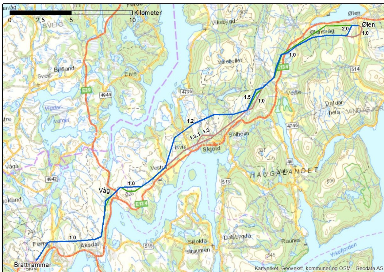
Figur 3-1 Konsesjonsgitt trase (blå linje), andre alternative omsøkte traseer (brune linjer) eksisterende ledninger som skal rives (grønn linje). Øvrige rivingsstrekninger er sammenfallende med trase 1.0.
