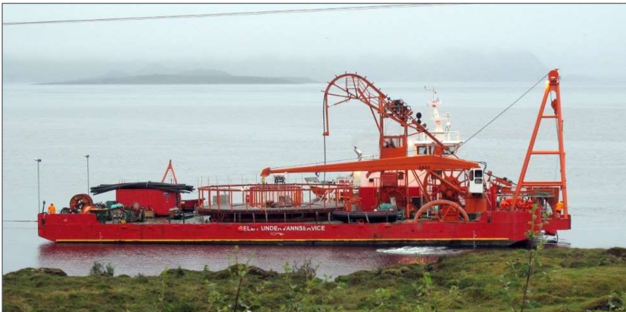
Figur 4-5. Eksempel på leggefartøy (Foto: Rana blad).
