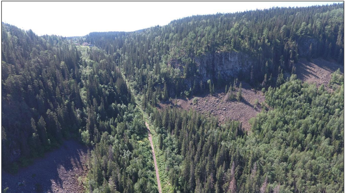
Figur 19: Dronebilde over turstien nedover Krokkleiva. Det er tydelige urer av skredmateriale i forkant av de bratte skråningene på hver side av stien, og dette er et typisk trekk ved de øvre delene av påvirkningsområdet.
