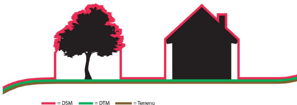
Figur 2-1 Illustrasjonen viser forskjellen mellom overflatemodell (DOM (her DSM)) og terrengmodell (DTM), og hvordan de ulike skanningene oppfatter de ulike elementene (Kilde: NIKU 2016).
