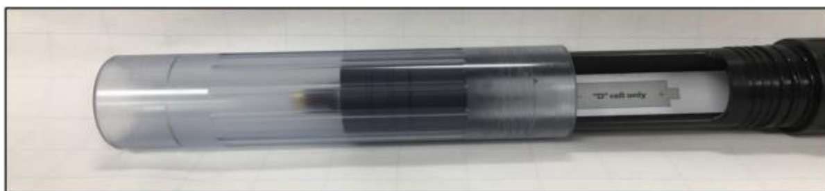
Figur 7. Apparatet som har vorte nytta til å måle Gassmetning i Fortunselvi. Monteringsoppsett for ein av dei fire gassmetningsmålarane i Fortunselvi er vist på framsidebiletet i denne rapporten.
