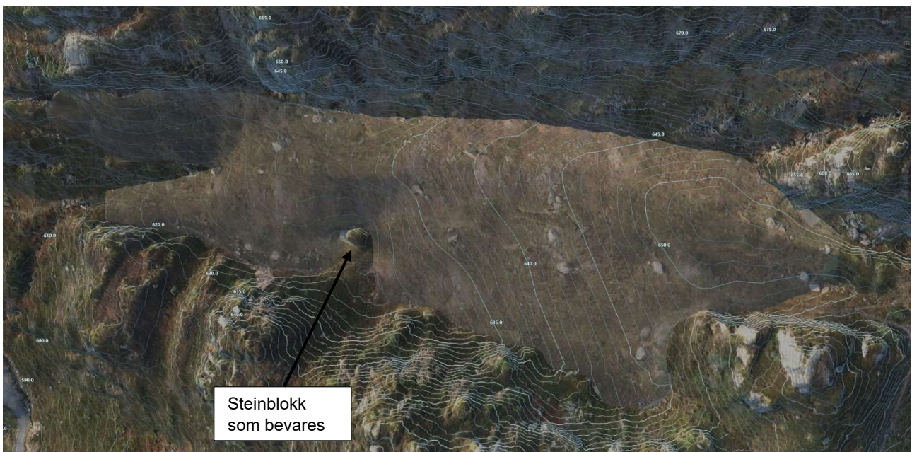
Figur 2-10: Illustrasjon av ferdig arrondert tunnelmassefylfylling, sett ovenfra. Nordlig retning er til høyre i illustrasjonen.
