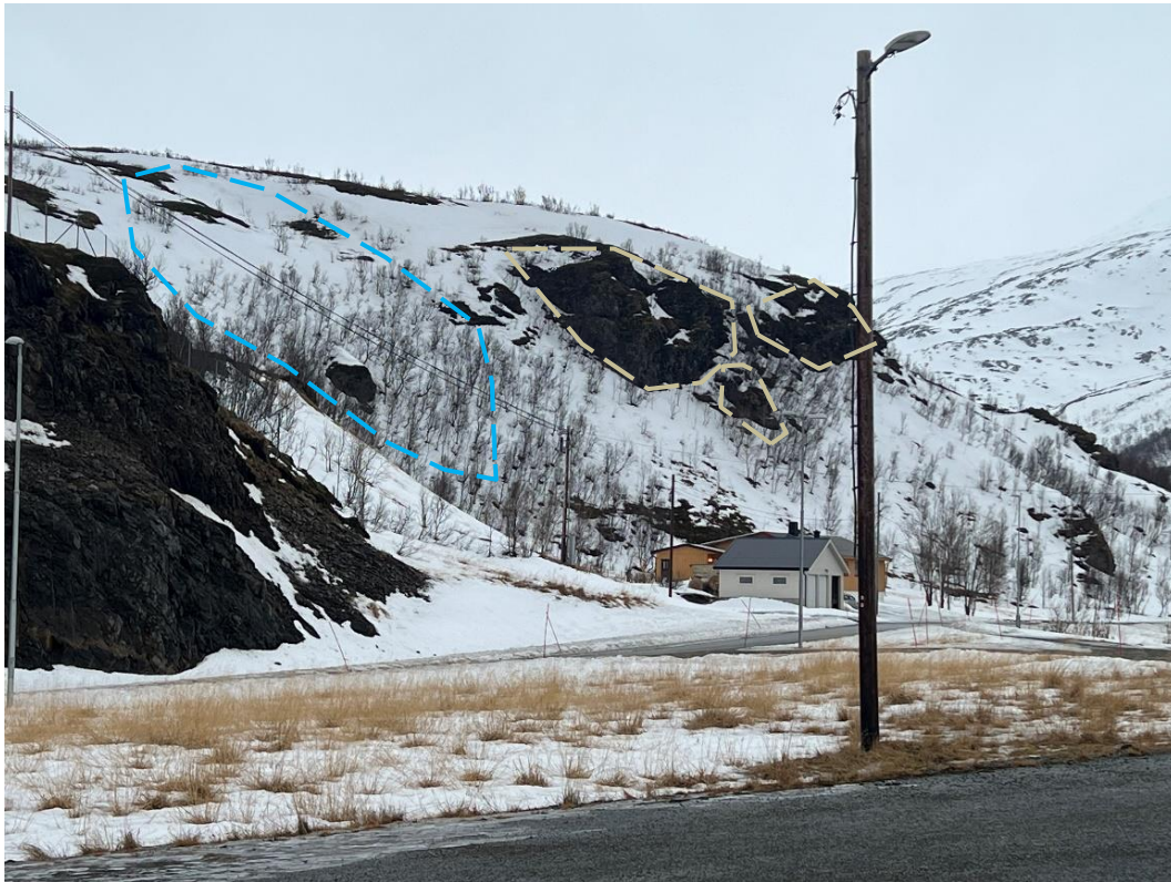
Figur 25: Terreng over hus nr. 746. Løsneområder snøskred markert i blått, løsneområder steinsprang markert i lys farge. Bilde tatt mot V.
