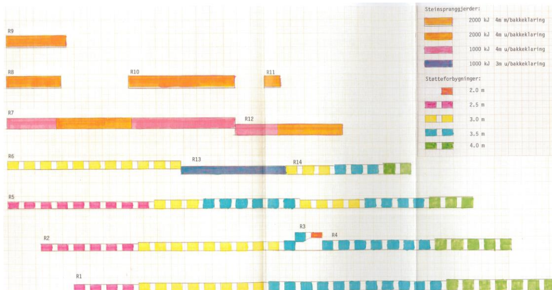
Figur 12: Steinspranggjerd og støtteforebygninger, med spesifisert høyde, lokalisering og styrke. Figuren er vedlegg til Teknisk beskrivelse, fra etableringen av støtteforebygningene, som ble utarbeidet av NGI i 2011. Det er ikke kjent for Sweco om tiltakene ble bygget som spesifisert i kravspesifikasjonen, eller om det ble gjort tilpasninger underveis i byggingen.
