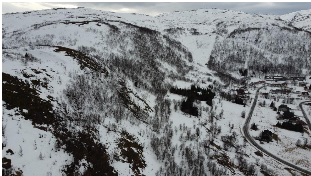
Figur 31: Bilde tatt mot vest. Blåmåseveien vises til høyre i bildet. Skråningen sør for Blåmåseveien har jevn helning over 30°. Bekkerskaret med Bekk 2 er synlig som forsenkning i siden. Litjeelva drenerer langsmed det åpne området som vises til høyre/midt i bildet. Skogen på vestsiden av Bekk 2 har betydning for løsneområder for snøskred og karakteriseres derfor som vernskog.
