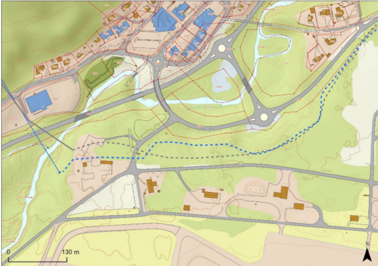
Figur 4: Punkt 3 – Andselva. Konesjonsgitt trasé er vist med grå strek og justert kabeltrasé er vist med blå strek.
