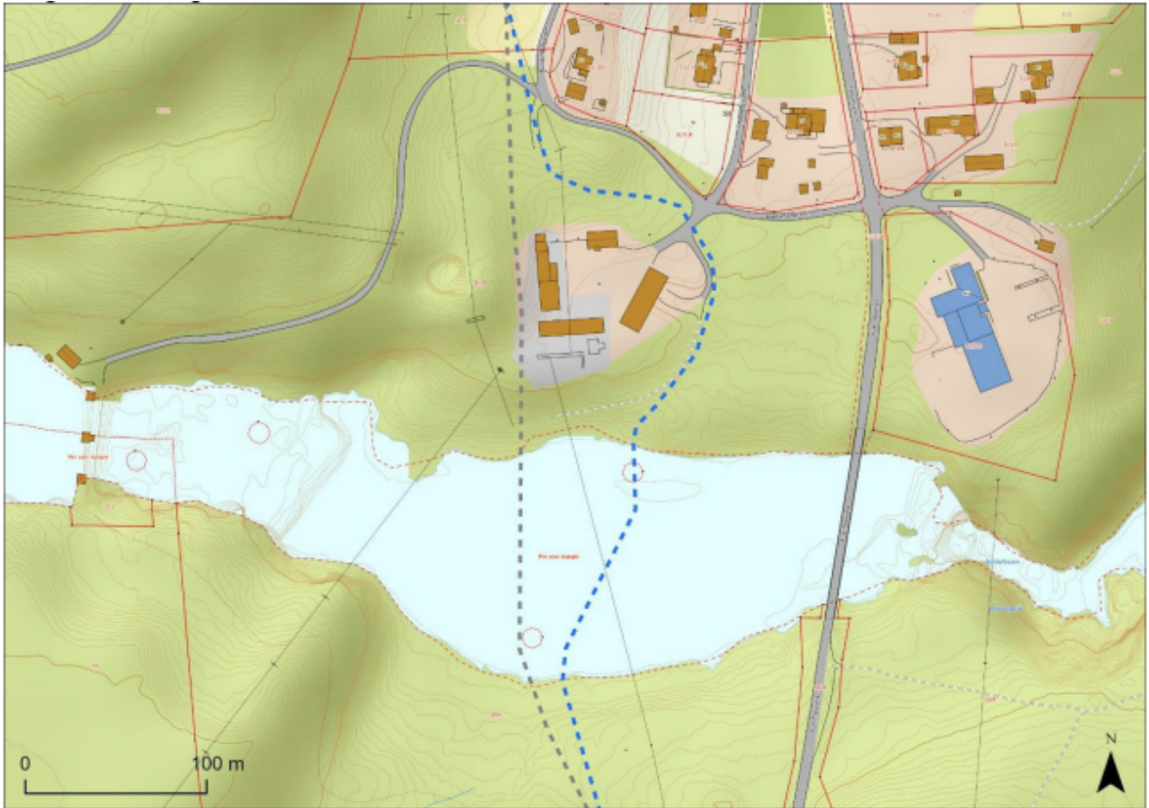
Figur 3: Punkt 2 - Kryssing av Barduelva. Kongsjonsgitt trasé er vist med grå strek og justert kabeltrasé er vist med blå strek.
