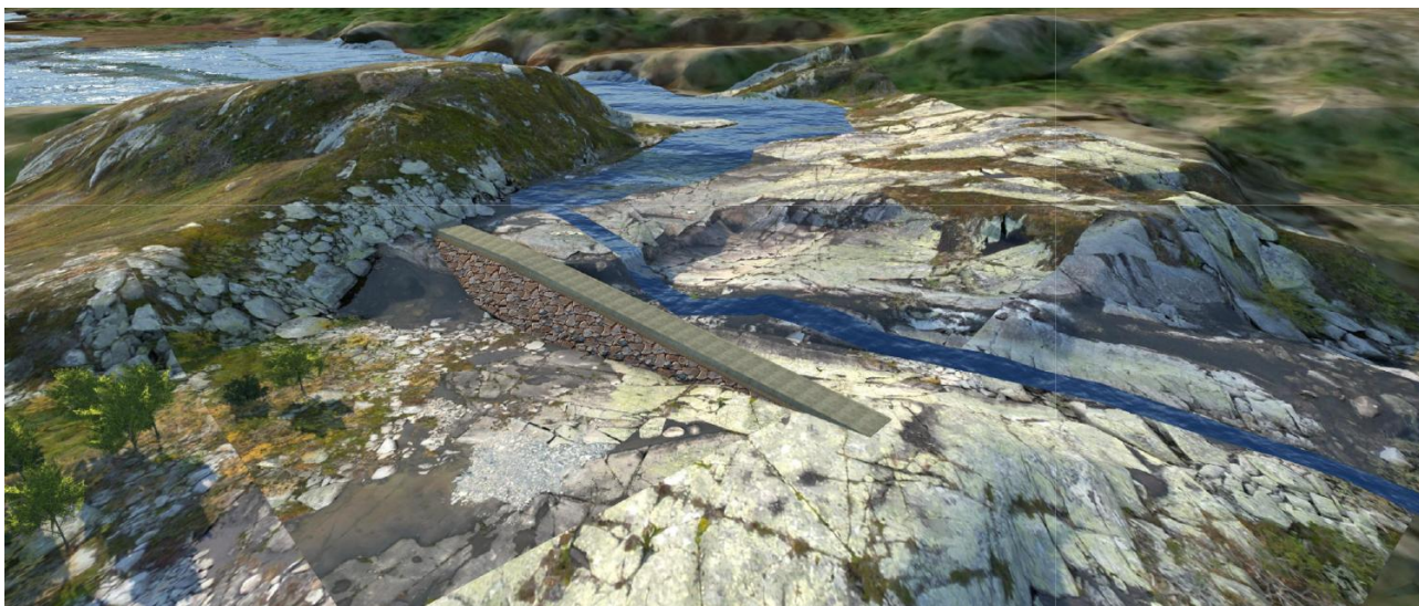
Figur 3-40. Illustrasjon av ledevegg med normal vannføring.
