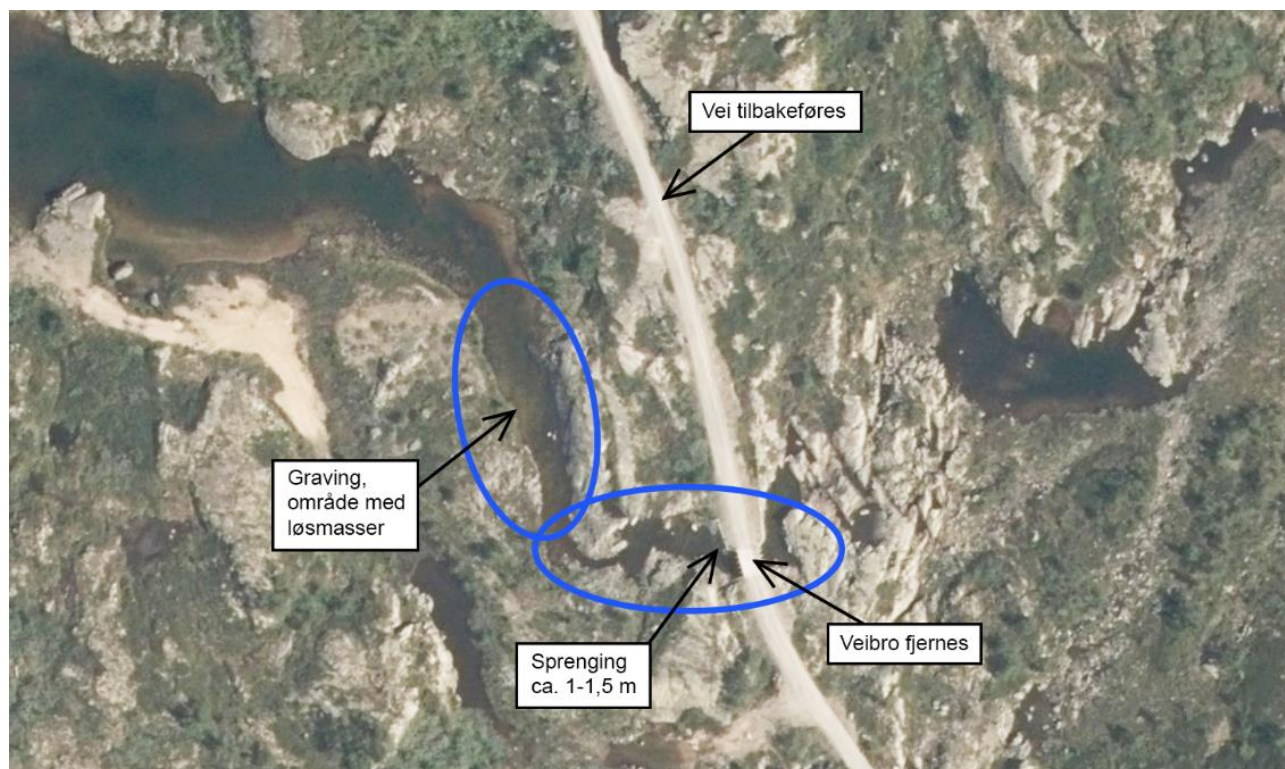
Figur 3-34. Området nedstrøms dam Grotte der det blir behov for terrengarbeider i forbindelse med kanalisering.
