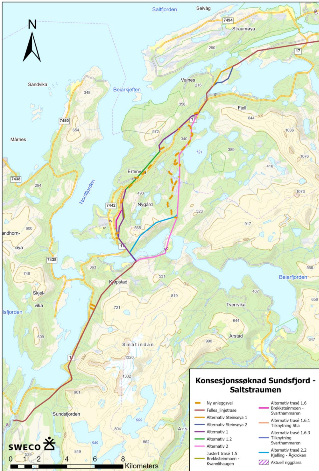
Figur 1-1. Omsøkte alternativer for 132 kV kraftledninger mellom Saltstraumen og Sundsfjord transformatorstasjoner. Kart Sweco
