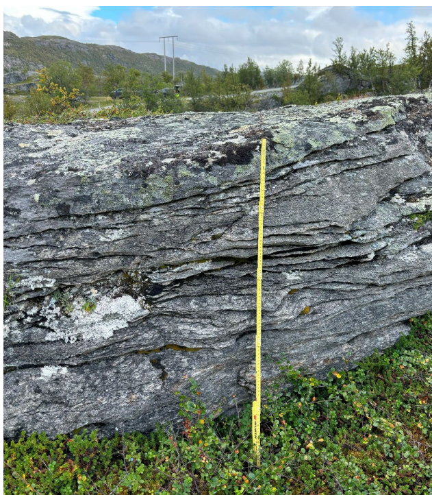
Figur 10: Til venstre - lys, grå gneis. Til høgre – tett mellom foliasjonssprekker i overflata (5-20 cm).
