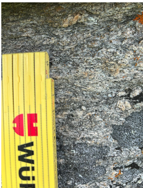
Figur 10: Til venstre - lys, grå gneis. Til høgre – tett mellom foliasjonssprekker i overflata (5-20 cm).
