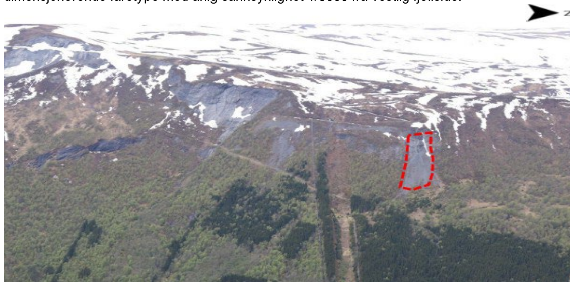
Figur 7 Bildet viser potensielle løснеområder for snøskred. Nedenfor svaberget lengst XX. På bildet vises også kraftledninger mellom Målset Kraftverk og Refsdal kraftverk. Kilde: NGI, 2023.
