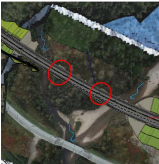
Figur 9: Søylene til brua må etableres på «halvøya» mellom Austerdalselva og Heggedalselva.
