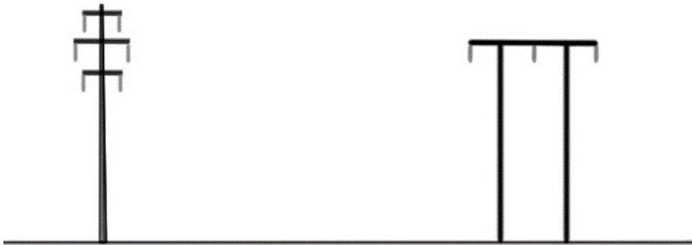
Figur 2-2 Mastebilde av dagens 66 kV-ledninger mellom Ølen, Våg og Bratthammar. Noen steder er det andre typer master, men ledningen til venstre er i all hovedsak en dobbeltkurs ledning med betongmaster, mens ledningen til høyre er en enkeltkurs trestolpeledning. Byggeforsbudsbeltet langs disse ledningene er 57 m bredt
