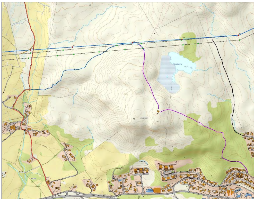
Figur 5-1 Ledningstraseen ved Alvanuten. Vurderte atkomstløsninger i anleggsfasen. Fiolett linje viser en mulig atkomst vist i konsesjonssøknaden, men som nå er skrinlagt. Svart linje viser atkomst for ATV som var vist i søknaden og som fortsatt er aktuell, Blå linje viser Tysvær kommunes forslag til atkomstveg til Alvanuten.
