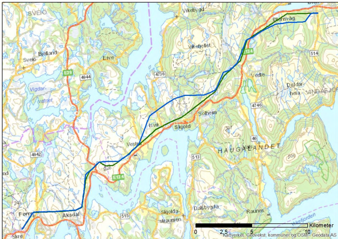
Figur 2-3 Prosjektert trase for ny 66 (132) kV ledning -blå strek, ledninger som skal rives – grønn strek
