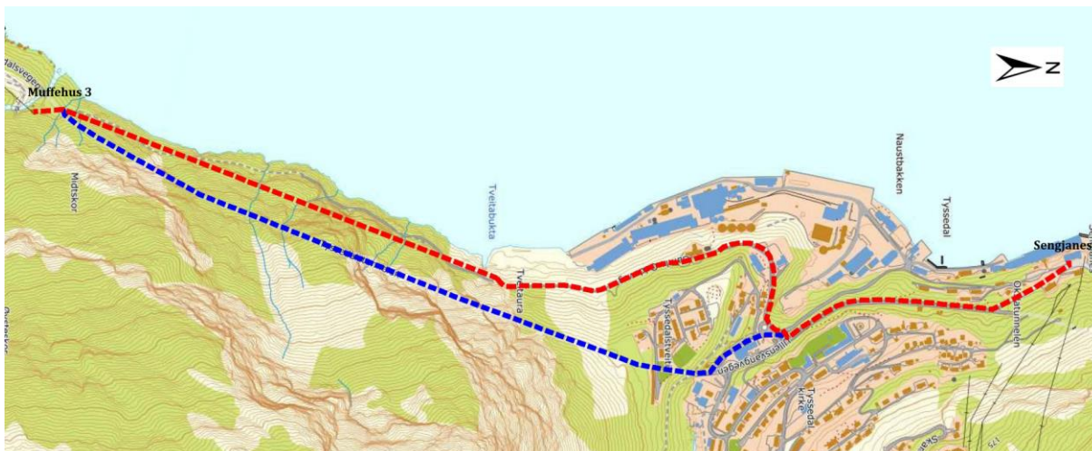
Figur 2: Omsøkte traseer for ny 66 kV jordkabel mellom Sengjanen og muffehus 3. Rød stiplet strek er alternativ 1, mens blå stiplet strek er alternativ 2.
