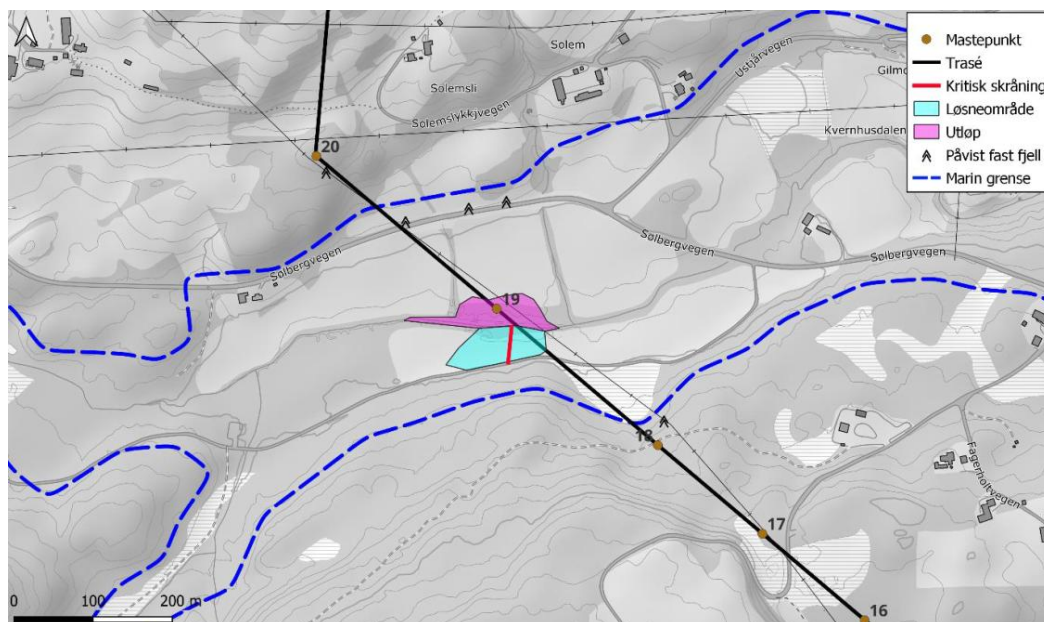
Figur 6-4: Løse- og utløpsområde med kritiske skråning ved mast 19.
