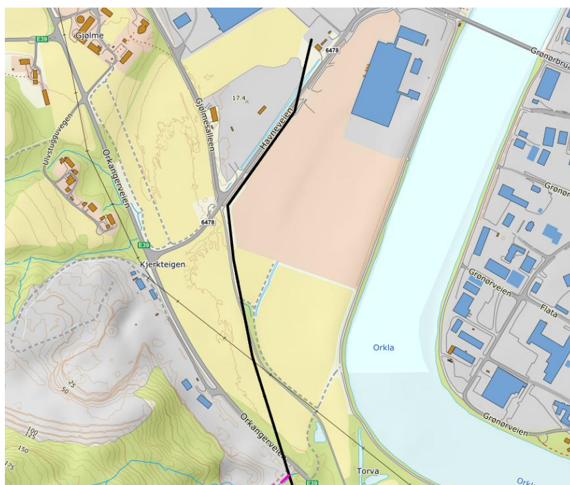
Figur 2-8: Eksisterende 66 kV-nett mellom ny og gammel Gjølme transformatorstasjon rives og saneres når nye nettanlegg er satt i drift.
