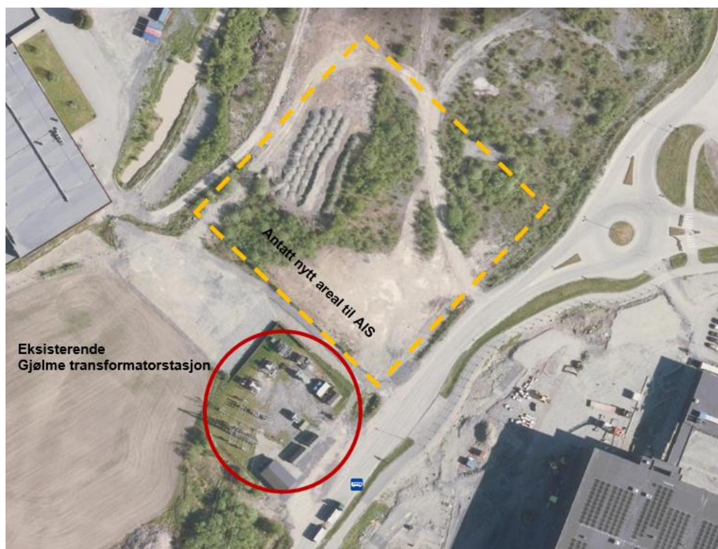
Figur 2-13: Eksisterende Gjølme transformatorstasjon med utvidet luftisolert bryteranlegg.
