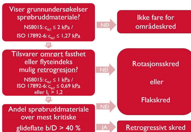
Figur 4: Flytskjema for vurdering av aktuell skredmekanisme [2]
