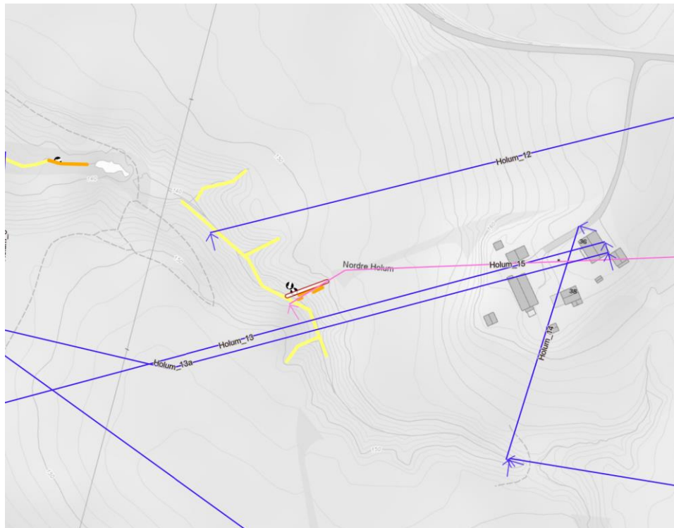
Figur 2-99: Erosjonsvurdering ved Nordre Holum 15. Helstrek: NVE, stiplet: Multiconsult. Rød/hvit strek er anbefaling om oppfølging av erosjon.
