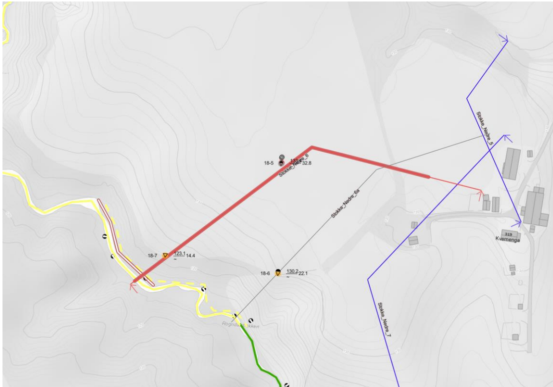
Figur 2-37: Erosjonsvurdering ved Stokke_Nedre_6 og 6a. Helstrek: NVE, stiplet: Multiconsult. Rød/hvit strek er anbefaling om oppfølging av erosjon.
