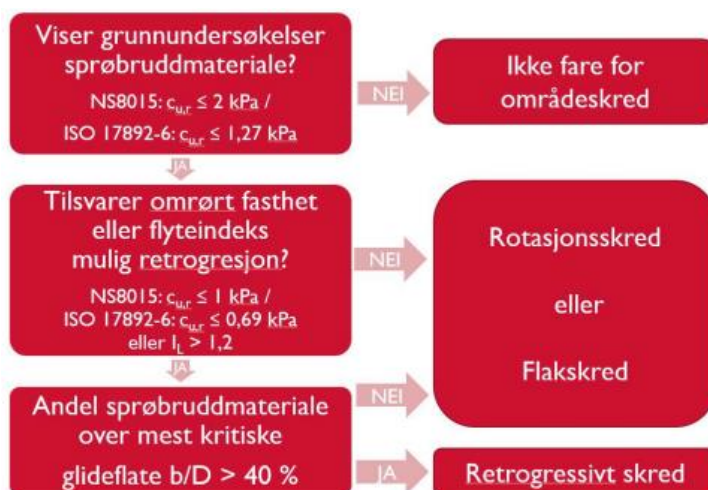
Figur 6.2: Flytskjema for vurdering av skredmekanisme iht. NVE-veileder nr. 1/2019.
