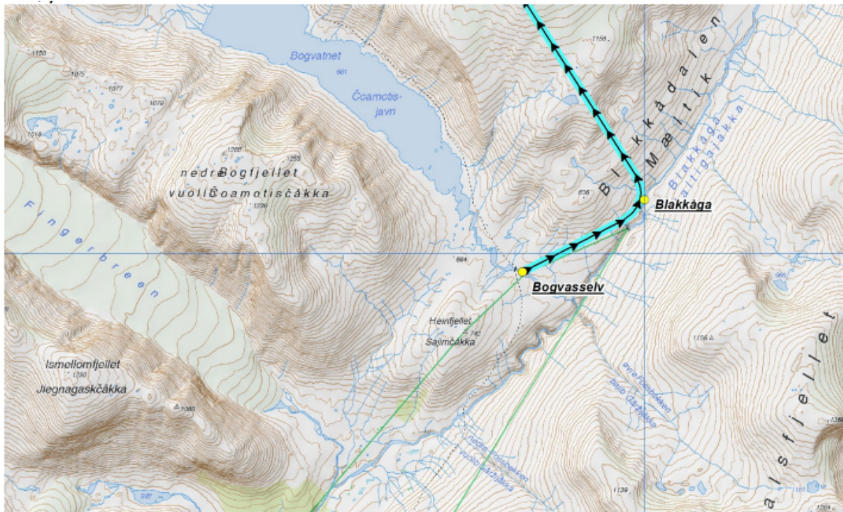
Figur 8.9 Kartutsnitt av bekkeinntakene i Blakkåga. De gule prikkene viser bekkeinntaket og den blå linja skisserer hvor takrenna/østoverføringen går.
