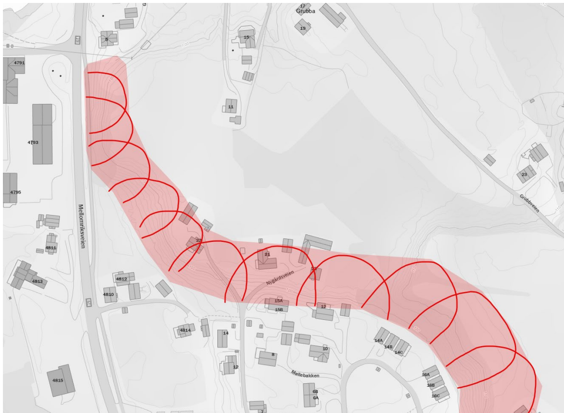
Figur 8: Eksempel overlappende rotasjonsskredmekanisme
