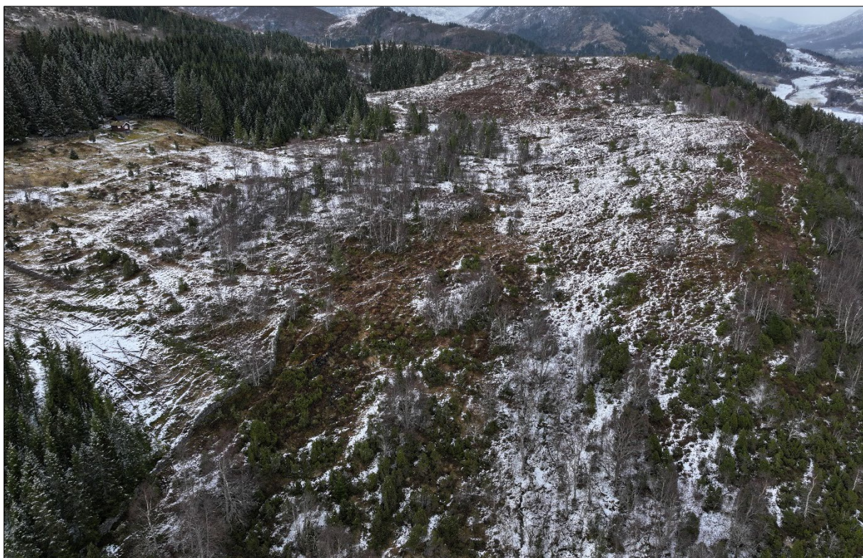
Figur 11: Bildet viser eksponerte løsmasser av tynne moreneavsetninger i øvre deler av påvirkningsområdet ved Vården og bart fjell med tynt løsmassedekke oppover fjellsiden.
