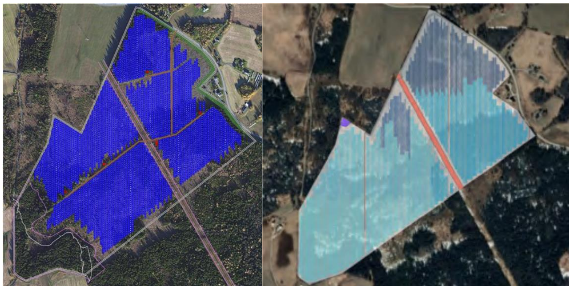
Figur 1. T.V.: Nye grenser for Store Nøkleberg Solkraftverk. T.H.: Opprinnelig plan for solkraftverket som ble vurdert i KU. Blå skraveringer viser solcellerader. Kilde: Energeia AS.
