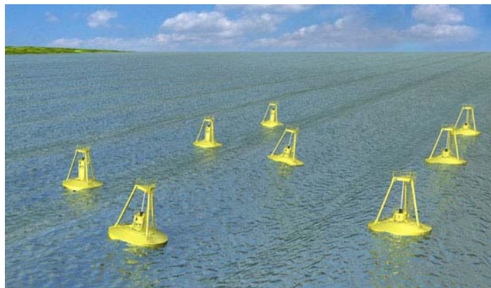
Bilde til venstre og illustrasjon til høyre: konsept for bølgekraftsbøyer Kilde: OPT – Ocean Power Technologies, USA
