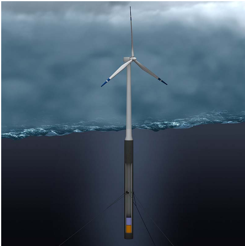
Illustrasjon: HyWind konsept for en flytende vindmølle Kilde: StatoilHydro
