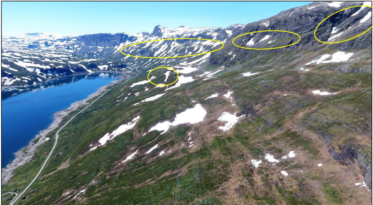
Figur 19: Store deler av fjellsiden fra Blåbergi og videre mot nordvest langs Strandavatnet inneholder løснеområder for snøskred, spesielt (men ikke utelukkende) innenfor de markerte ellipsene.
