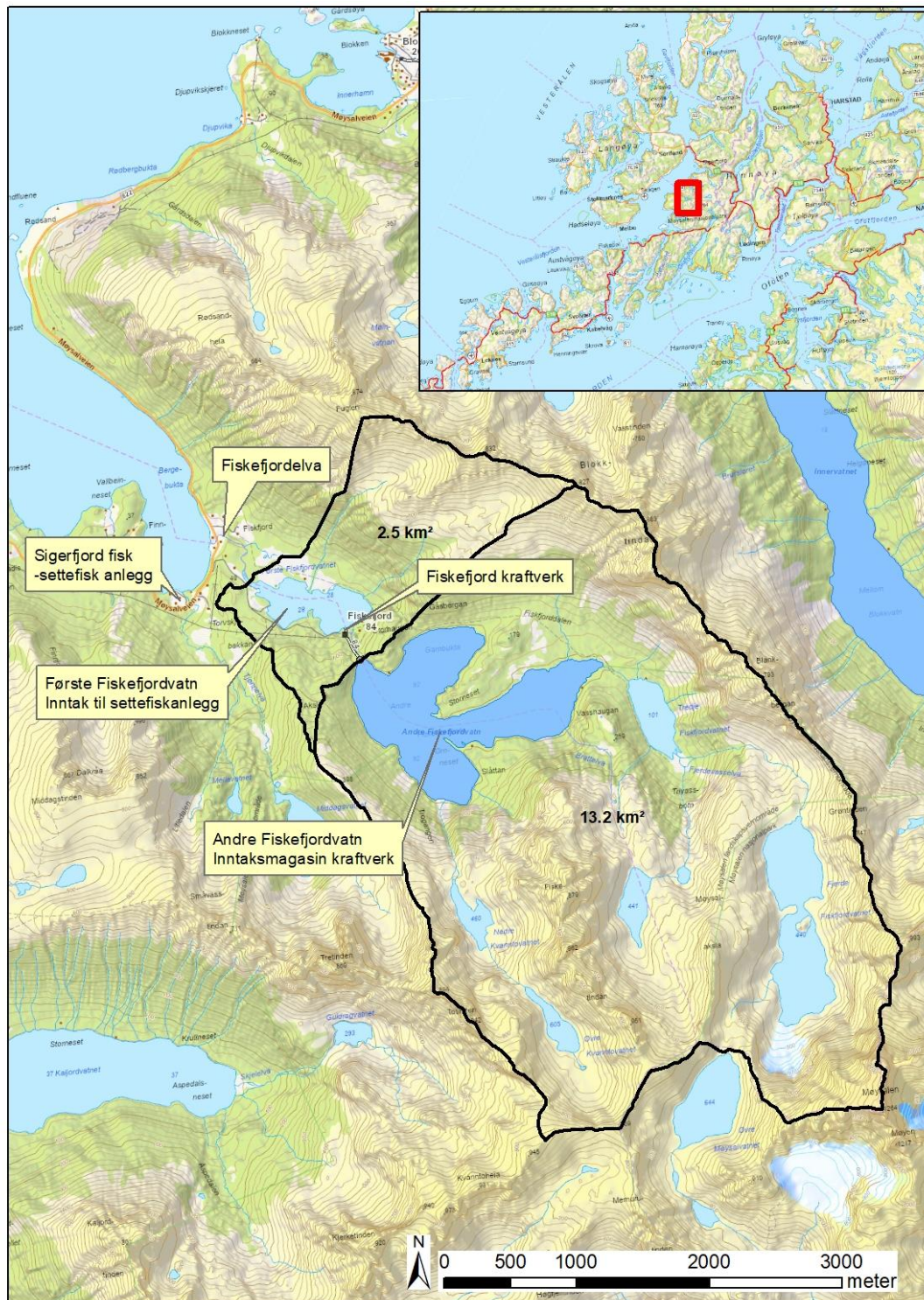
Figur 1. Fiskefjordvassdraget, Nedbørfeltet til Fiskefjord kraftverk og felt til inntak til Sigerfjord settefiskanlegg.
