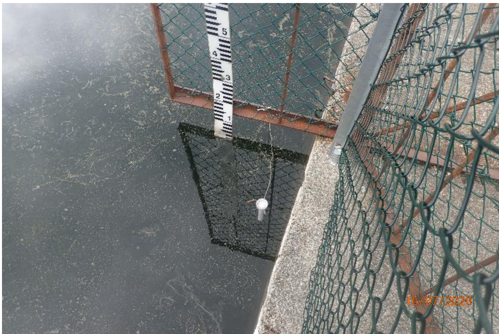
Bilde 8, montert målestav for vannstand
