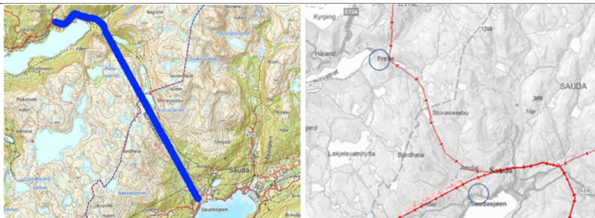
Kart 8: Sauda kommune og andre sitt forslag om kabel i tunnel mellom Sauda og Etne til venstre. Dagens ledning med forslag til tunnelåpninger til høyre. Kilde: Høringsuttalelse Sauda kommune.
