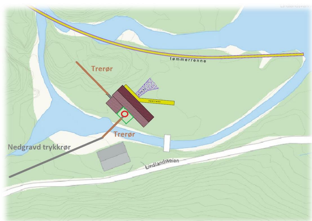
Skisse 8. Plan for Lindlandsaga med gammel og ny kraftstasjon innebygget
