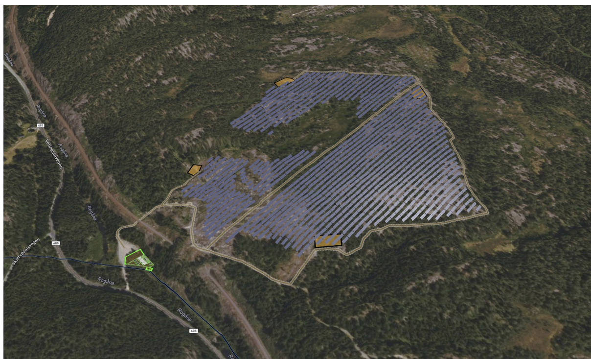
Figur 6: Planlagt utforming vist på kartgrunnlag, med solcellefelt, interne veier, høyspentområde og riggområder. Kilde: Solkraft Sør AS.
