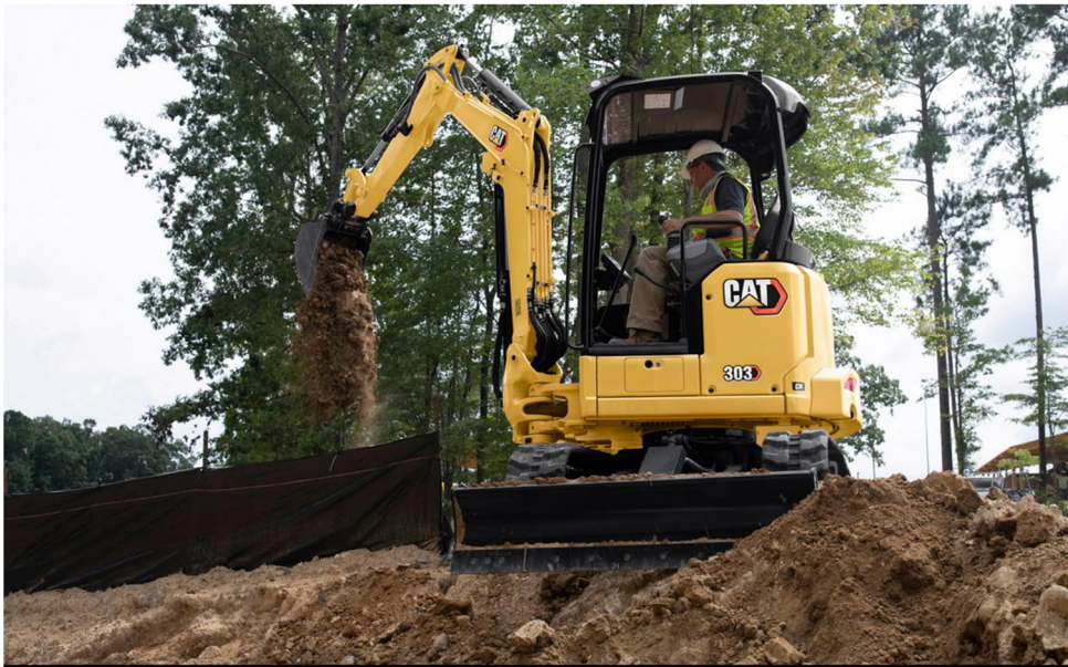
Figur 7. Illustrasjon av Cat 303 CR hentet fra Caterpillars nettsider ( www.cat.com ). Maskinen veier ca. 3,5 tonn, og tilsvarende eller noe større maskiner vil kunne demonteres og flys inn med helikopter.
