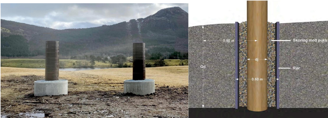
Figur 5. Eksempel på nedgravd fundament fra Comrod sine nettsider (venstre) og Renblad 2012 (høyre) ( www.comrod.no/fundamenteringen ).
