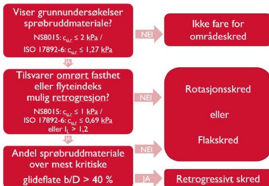
Figur 4.3 Flytskjema for vurdering av aktuell skredmekanisme
