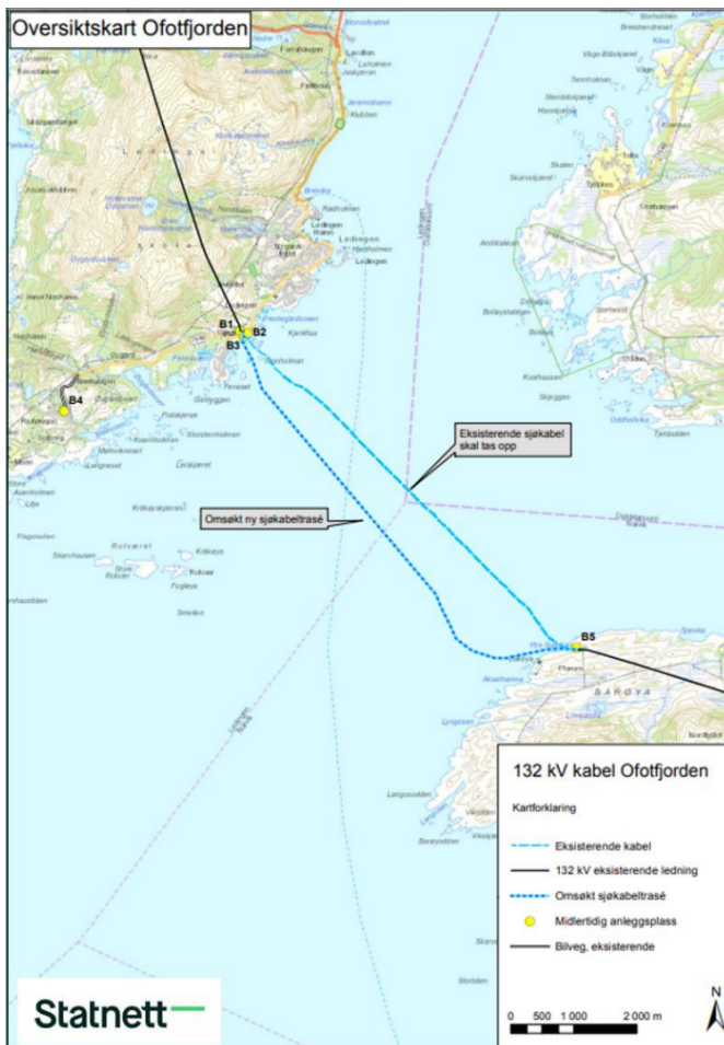
Figur 1: Kart over sjøkabelforbindelsene som skal bygges og fjernes over Ofotfjorden. Kartet viser også plassering av midlertidige riggplasser/anleggsplasser. Kilde: Statnett sin detaljplan, 29. januar 2026
