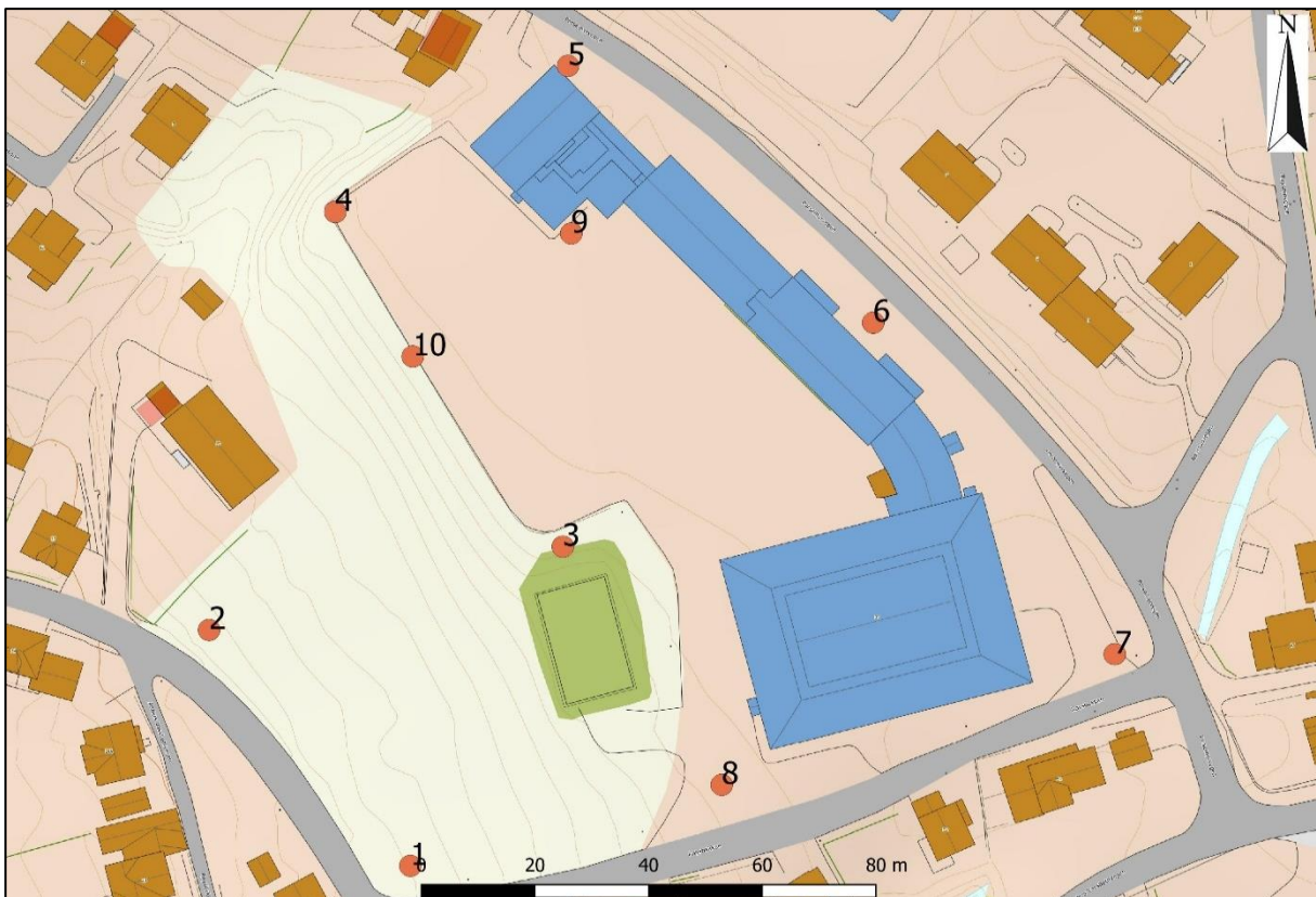
Figur 7: Boreplan for totalsonderingar ved planlagt ny ungdomskule i Volda. Det er totalt utført 10 totalsonderingar.
