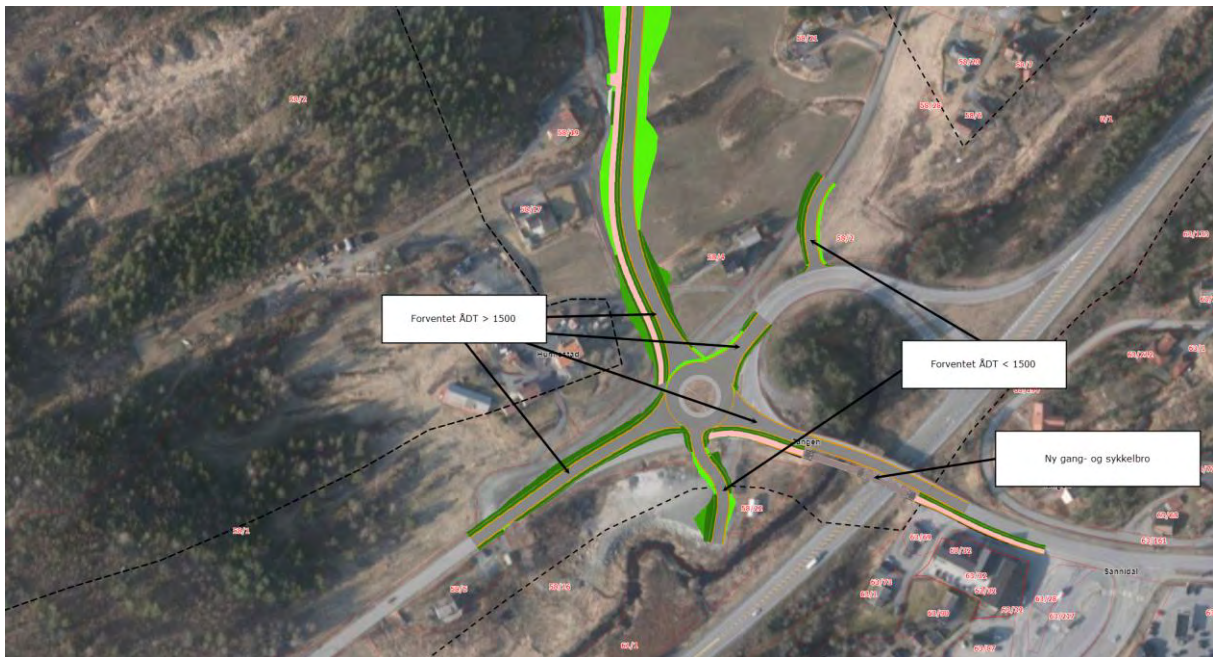
Figur 4-2: Planlagte tiltak ved Humlestad med forventet ÅDT for ulike tiltak innenfor kartleggingsområdet.
