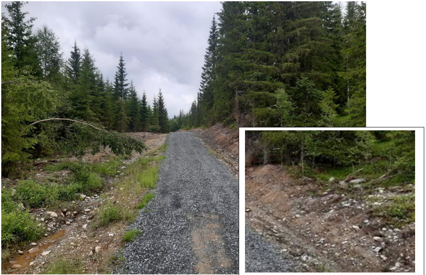
Figur 9. I de områdene vi har veiskjæringer og nyere grøfter kan vi danne oss et bilde av jordbunnsforholdene. Selv om det er noe stor stein i overflata tyder det på at morenemassene inneholder siltjord med mindre stein og grus.
