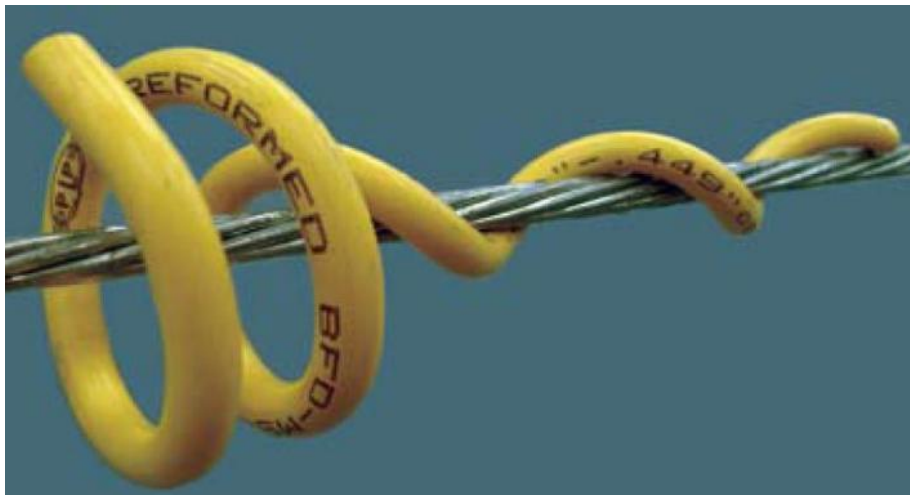
Figur 6-2: Plastikkspiraler festes på en av faselederne for å hindre fuglekollisjoner.
