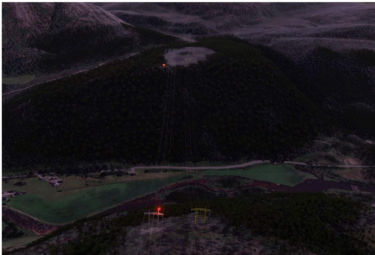
Figur 4.3.6.2 - Visualisering av hinderlys for spenn mellom M18 og M19 for dalspenn sett fra høyde over eksisterende 420 kV-ledning fra vestsiden av Austredalen. Ledningen til høyre i bildet viser ÅEVKs planlagte 132 kV-ledning Øygard – Honna og ledning til venstre i bildet viser Statnetts eksisterende 420 kV-ledning.
