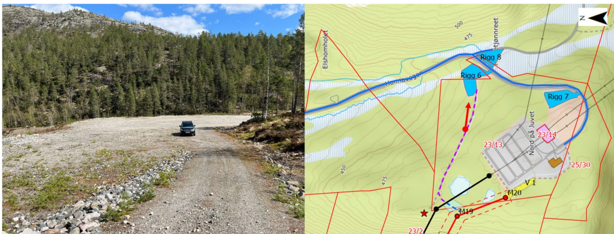
Rigg 6 ved Honna TS. Det legges opp til montasje og utflyging av master med helikopter fra eksisterende opparbeidet massedeponi/riggplass til Øygard TS. Rigg 6 vil bli hovedbase for helikopter og depot for bunkring av drivstoff. Bildet er tatt i retning mot øst i fra opparbeidet adkomstvei (fiolett stripet strek) til 420 kV-ledning på Honna TS. Areal til rigg 6 berører delvis g/b-nr 23/1 og 23/13.
