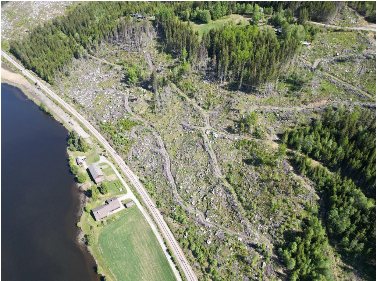
Figur 1: Nedre deler av kartleggingsområdet har grovere løsmasser. Dette er med på å redusere løsnesannsynligheten for både jordskred og snøskred. Jordskred da vann drenerer bedre, og det skal mer til for at det bygger seg opp et poretrykk. For snøskred vil ruheten hindre oppbyggingen av sammenhengende flak av snø. Bildet er tatt mot sørøst, med drone.
