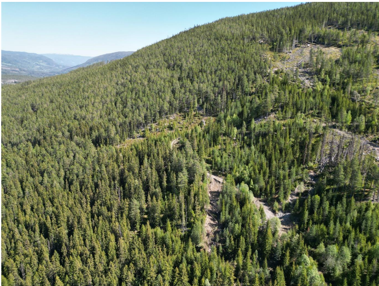
Figur 6: Dronebilder avdekte at det er flere skred som har gått i påvirkningsområdet. Her vises et, nr 2, som har gått fra kote + 585, fra skogsbilveg. Skredmasser nådde ikke ned til kartleggingsområdet. Skredet ble trolig utløst under ekstremværet «Hans» i perioden 07-08.08.2023.
