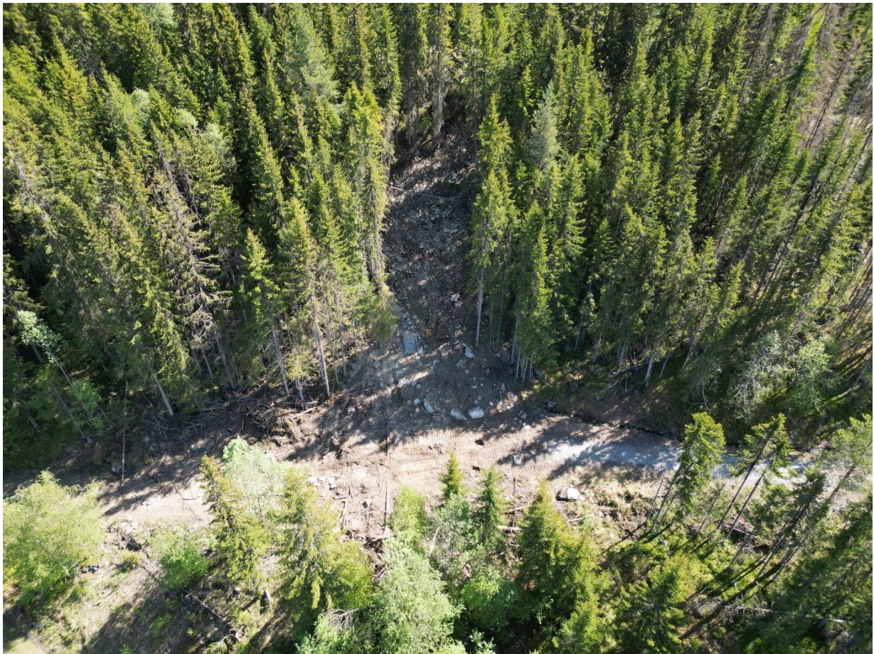
Figur 2: Skred som har gått inn i kartleggingsområdet, ned på skogsbilveg. Dette skredet er gitt som nr.1 og ble trolig utløst under ekstremværet «Hans» i perioden 07-08.08.2023. Bildet er tatt mot S, med drone.
