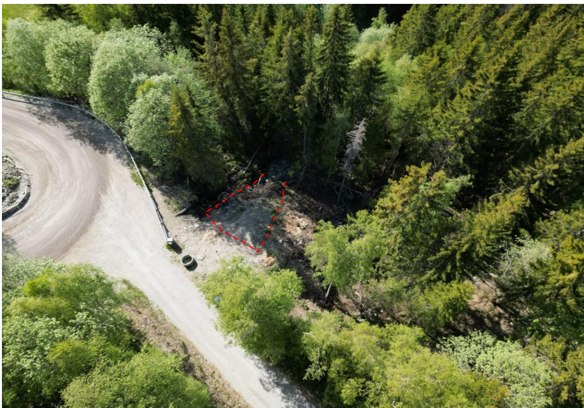
Figur 12: Utrast fylling ved infopunkt 10 (merket med rødt omriss), helt øst i kartleggingsområdet, på nedside av Vestlivegen. Utløst som følge av høyere vannføring enn normalt i eksisterende bekkeløp under ekstremværet «Hans». Bilde tatt med drone, ser mot nord. Det er inntegnet faresone for jordskred i dette området, basert på at det er høyere avrenning og terrenget har en helning som legger til rette for jordskred.
