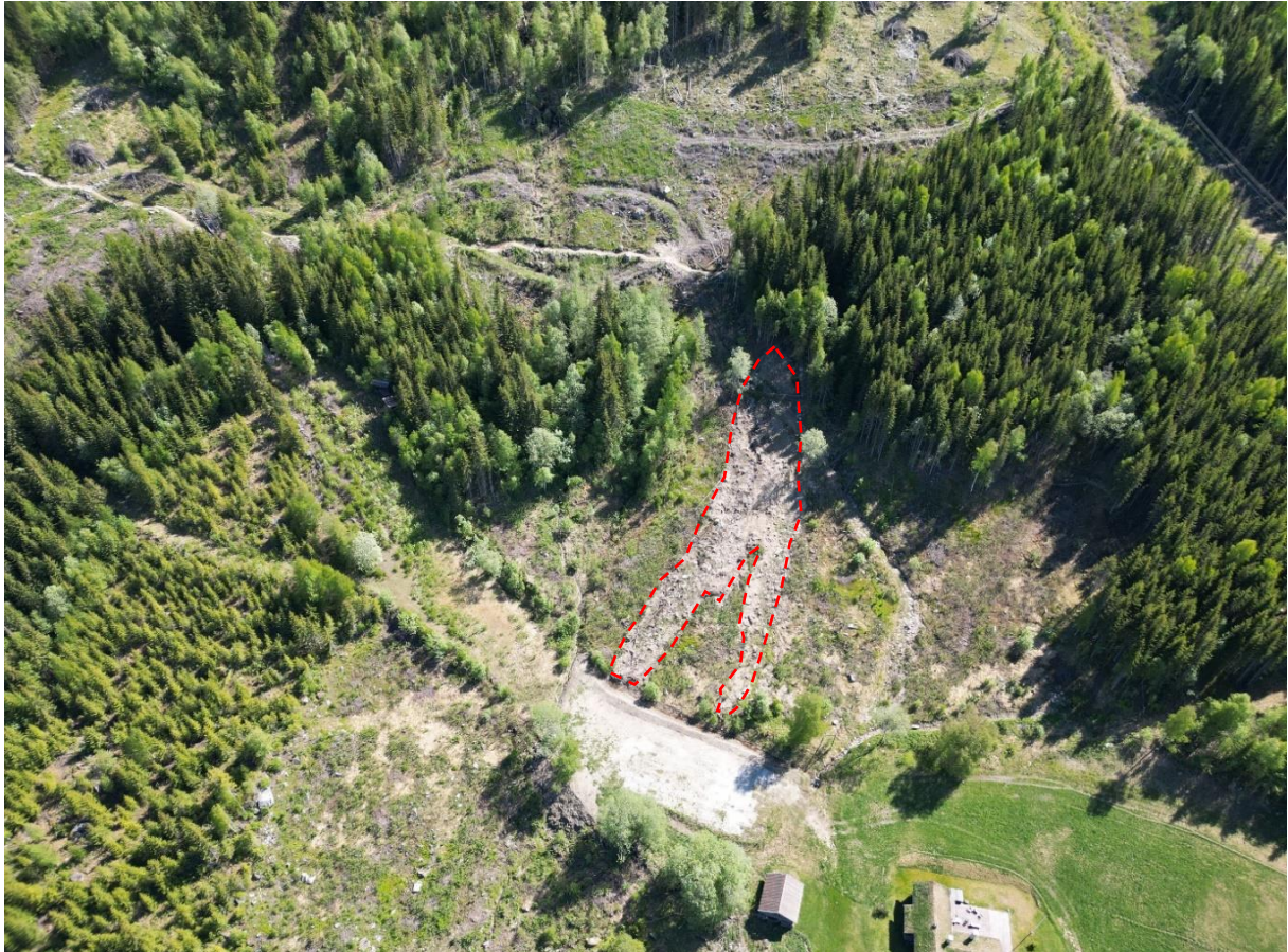
Figur 16: Dronebilde tatt mot sør av jordskred som gikk ned til Bråten» (utløpet slik det ses i dag er merket med stiptet rød linje). Utløst under ekstremværet "Hans", 08.08.2023. Skredet hadde utløp ned til grå flate, med slam og vann hadde lengre utløp. Skred nr.4.
