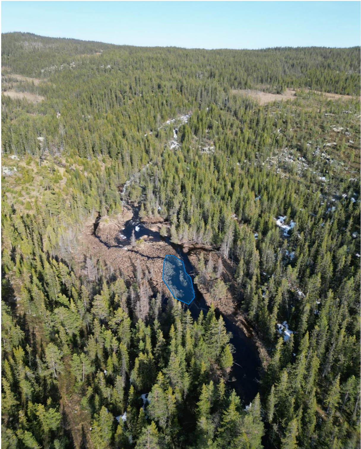
Figur 1: Mulig løснеområde for sørpeskred langs med elveløpet til Kulu på kote + 910 (merket blått). Dette terrenget er utenfor hva som er definert som påvirkningsområde, men det representerer et typisk område der vann kan demme seg opp i snødekket og videre bli utløst som et sørpeskred som følger løpet til Kulu.
