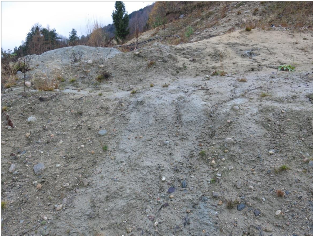
Bilde 2. Løsmasser som finnes innenfor planområdet består hovedsakelig av sand og silt, og andre breekvavsetninger. Bildet er tatt ved Ulvhaugen.
