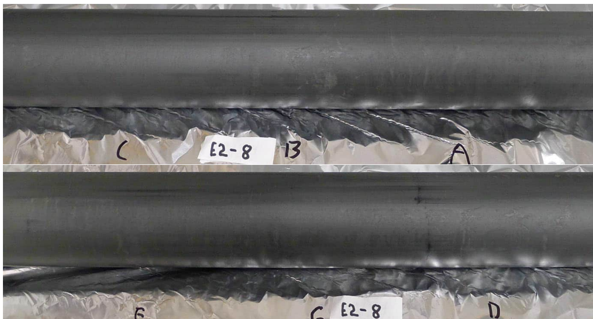
Pr. 9, 54 mm prøve, dybde 18,2-19,0 m: Fin prøve. Leire, ikke kvikk.
