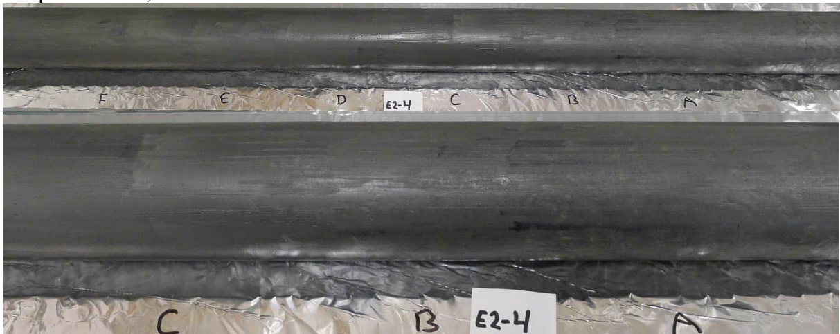
Pr. 4, 54 mm prøve, dybde 8,2-9,0 m: Fin prøve. Leire, kvikk.
