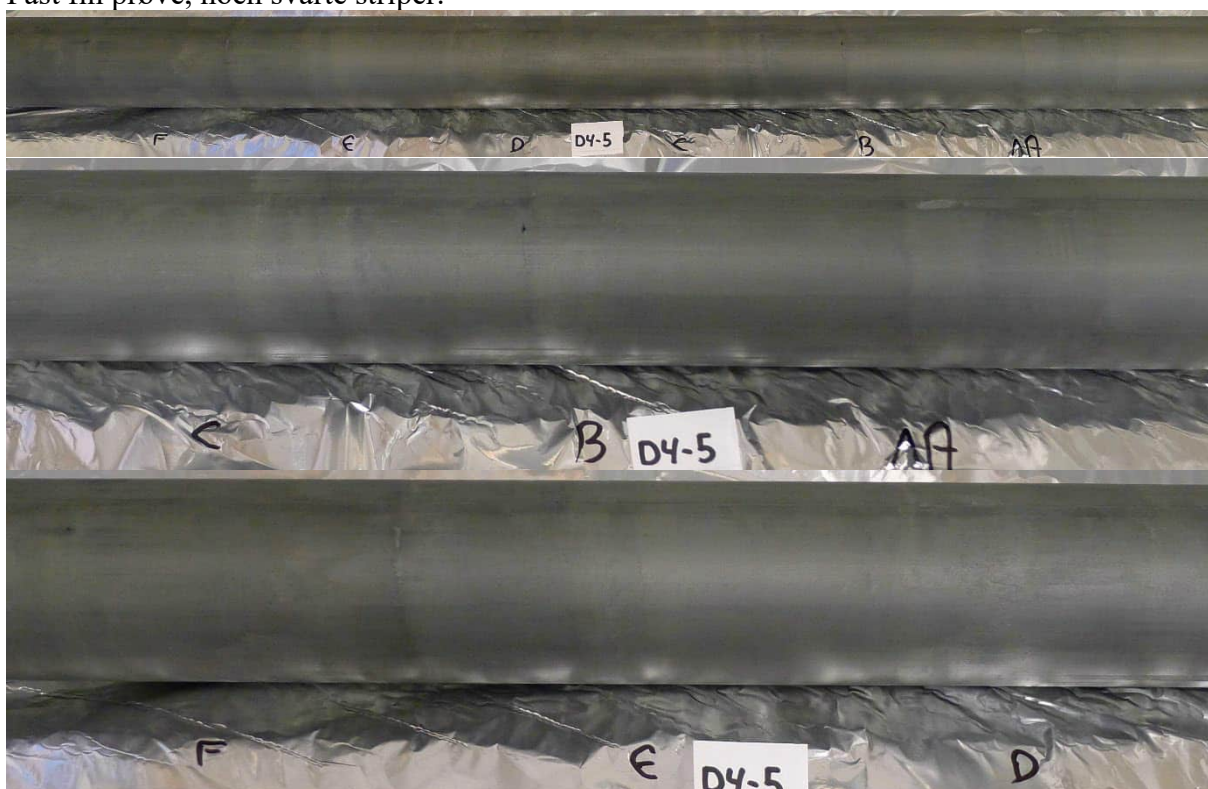
Pr. 5, 54 mm prøve, dybde 6,2-7,0 m: Fast fin prøve, noen svarte striper.
