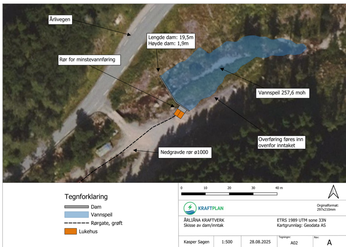
Figur 9: Enkel skisse av dam/inntak
