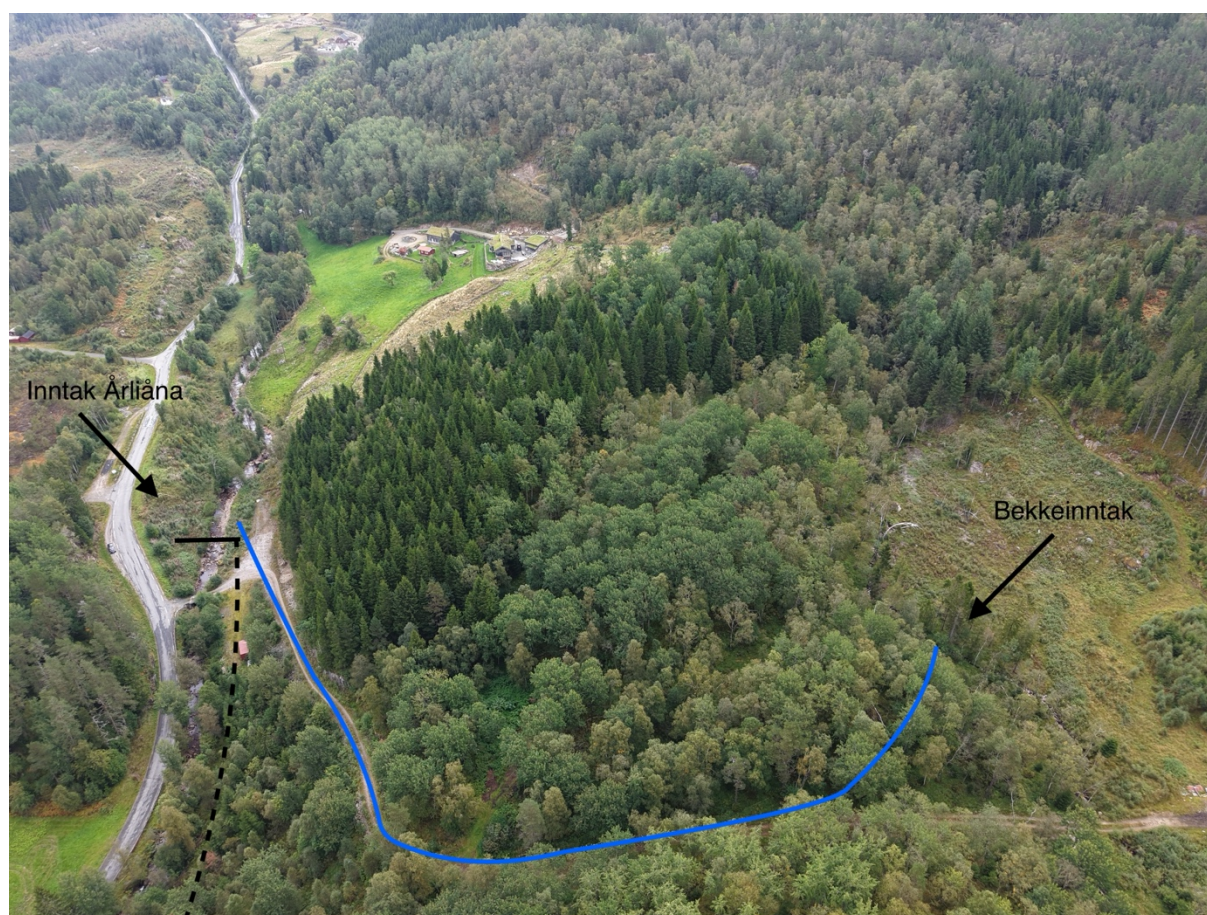
Figur 7: Enkel skisse av overføring på dronebilde
