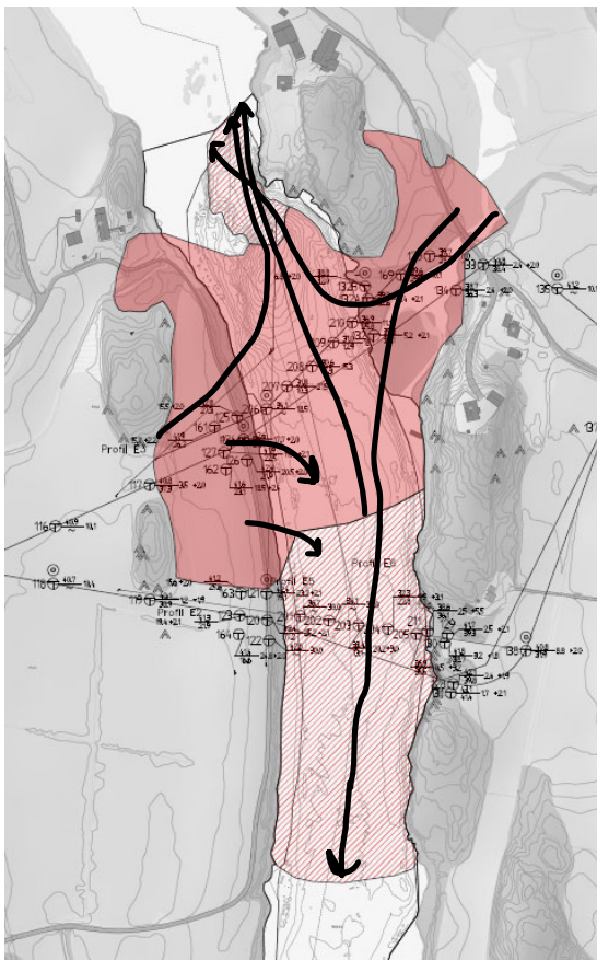
Figur 14 Forslag til utløpsområde. Forventet retning på utglidning er skissert inn.
