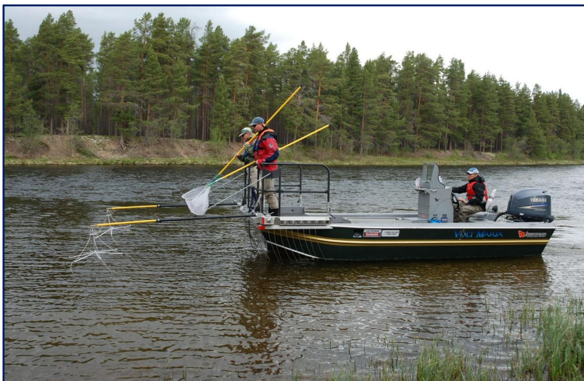
Bilde 5. Under elektrisk båtfiske i fire elver på Sørlandet høsten 2019 ble det benyttet en 18 fots aluminiumsbåt med en 200 hestekrefters utenbordsmotor med vannjet. Illustrasjonsbildet er fra en tilsvarende undersøkelse som ble gjennomført i Rena. Foto: Jon Museth, NINA.
