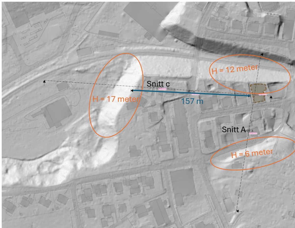
Figur 11: Kritiske skråninger som kan ramme tiltaket.
