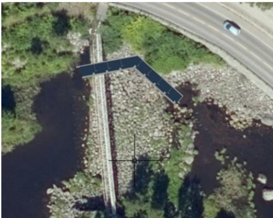
Figur 3-30. Forslag til lokalisering og design på vertikalspaltet trapp nedfelt i steinterskel 3. Innhoppet lokaliseres i elvas djupål og traseen gjennom steinterskelen legges inn mot nordre elvebredd. Uthoppet legges i ei bakevje, der strømningsforholdene og sedimenttransport er lavest ved store vannføringer. Dette vil redusere risikoen for at trappa skal fylles av løsmaterialer eller bli ødelagt av store steiner som kommer i bevegelse ved de største flommene.
