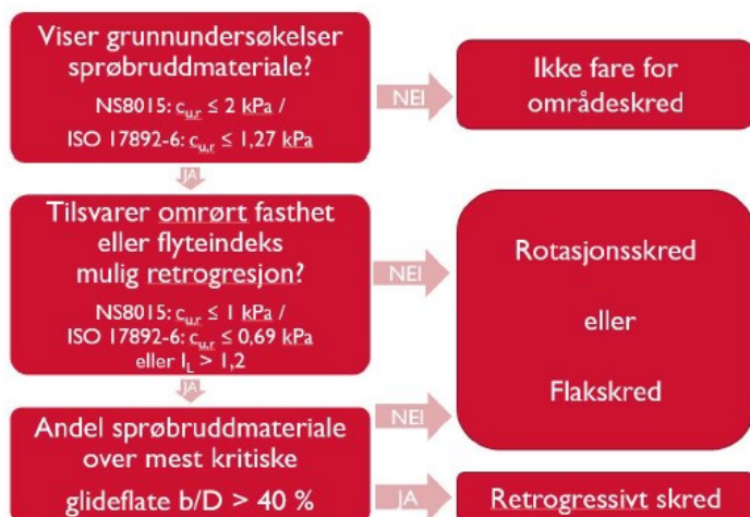
Figur 5-1 Utklipp av figur 4.3 i NVE veileder 1/2019 [1]. Benyttet for å fastslå relevant skredmekanisme.
