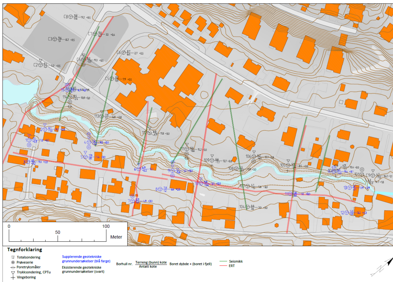
Figur 3-5 Oversiktskart over tidligere (svart) og supplerende (blå) borepunkt langs Bøbekken med utført ERT (rød) og seismiske linjer (grønn) markert.
