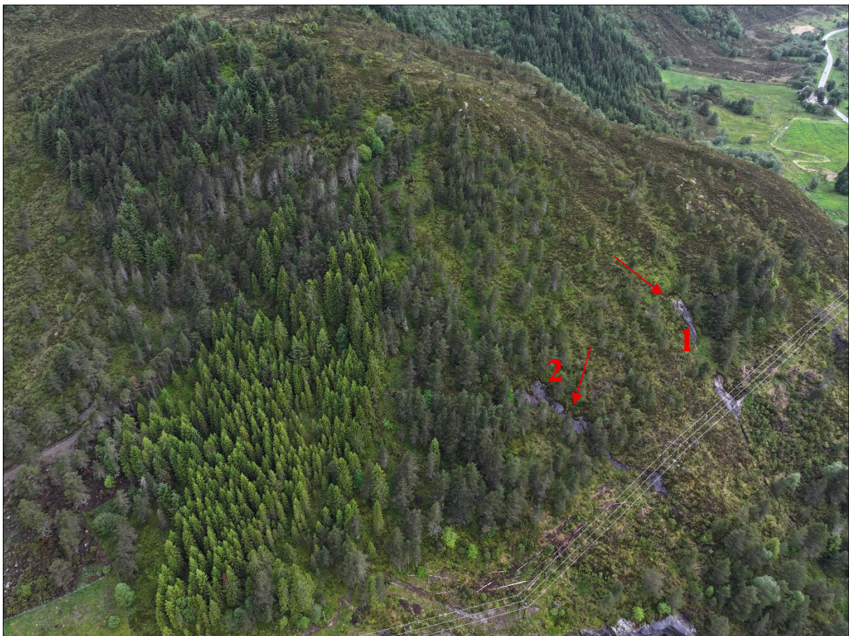
Figur 10: Oversiktsbilete over kartleggingsområde viser vegetasjonsskilje mellom sørleg og nordleg del av området. Den nordlege delen vender ut mot havet og er meir påverka av vind og vær. Dette gjev mindre vegetasjon til å ta opp vatn, og lausmassane blir raskare vassmetta under nedbørshendingar. I terreng med helling over 40 grader har dette ført til jordutglidingar (raude piler). Flyfoto viser at det skredspora i renna (1) har skjedd ein gong mellom 2006 – 2013, og i skråninga (2) har det vore bart fjell sidan før tidlegaste flyfoto (1968).
