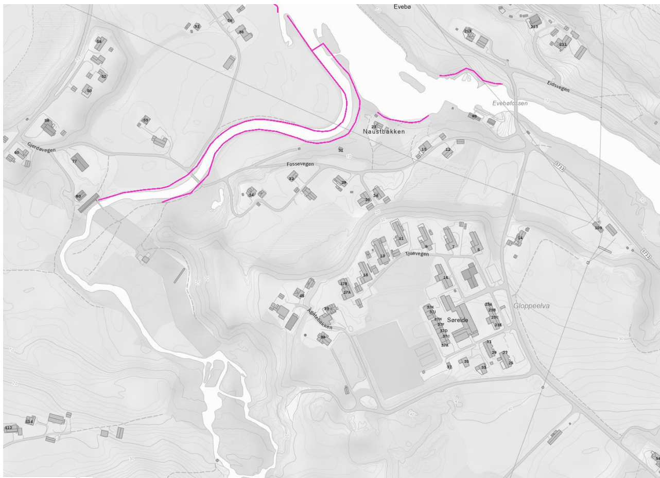
Figur 3-4: Sikringstiltak langs elv er vist med rosa grenser [3].
