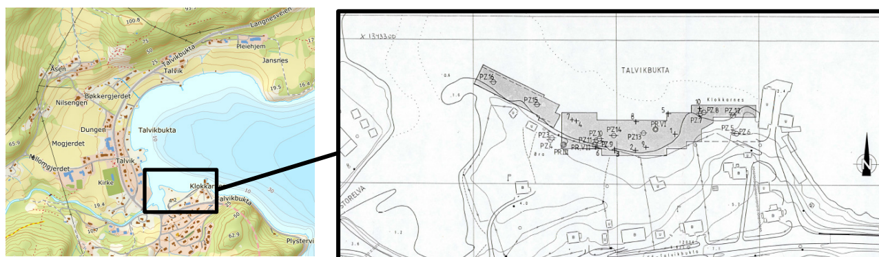
Figur 2-3 Oversiktsfigur over kalksementstabilisert område mellom Klokkarneset og Storelva i sone 1715 Talvik sør
